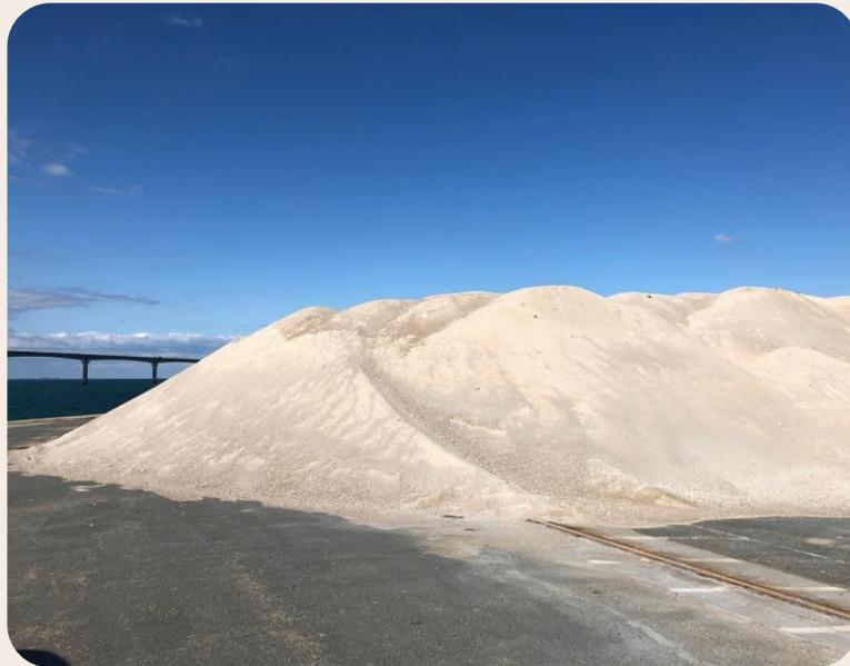
Stock de 50 000 tonnes de laitier de haut-fourneau détenues par Hoffmann sur le port de La Rochelle
